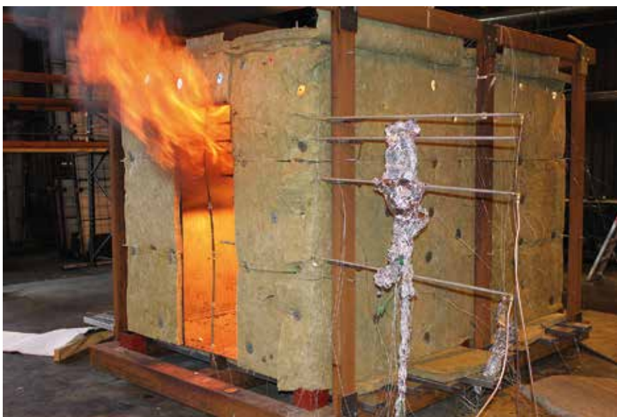
Mätning av termisk exponering från en fullt utvecklad brand i ett isolerat rum. Plattermometrar är monterade i dörröppningen. Försöket genomfördes vid RISE Fire Research i Borås och fotot togs av Johan Sjöström.
