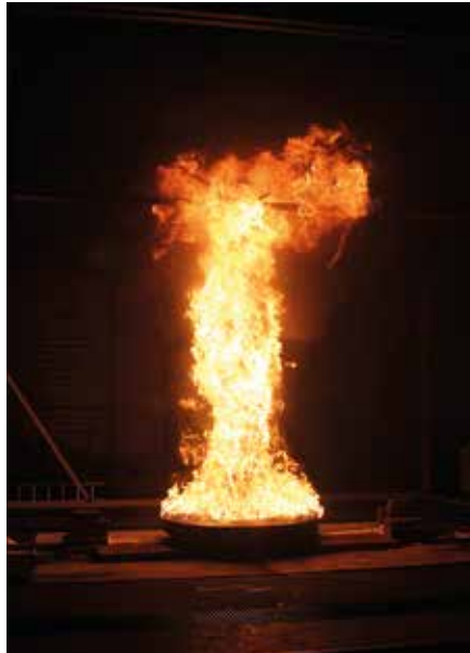
Ett fackverk utsätts för en så kallad lokal brand. Försöket utfördes vid RISE Fire Research AS i Trondheim. Fotot togs av Joakim Sandström.
